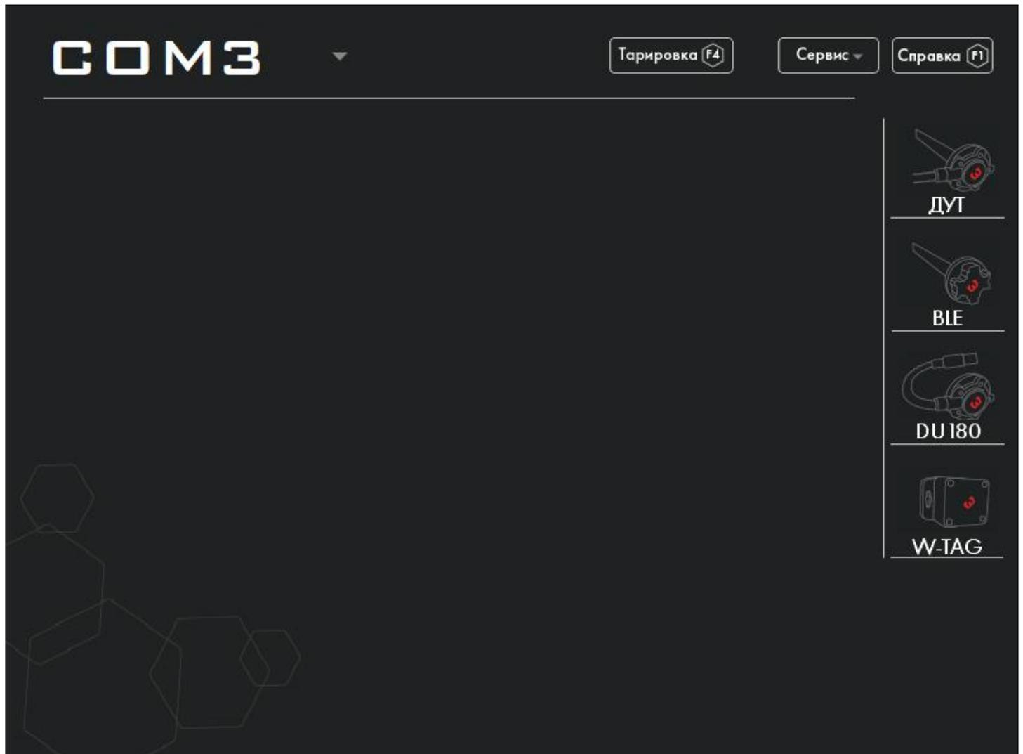
При подключении преобразователя USB <> RS-485 автоматически определяется COM-порт. Поиск подключенного датчика уровня топлива происходит при нажатии кнопки ДУТ (для датчиков ТД-100, ТД-150, ТД-500, ТД-600).
