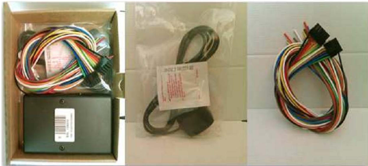
Рис.2. Устройство FM Pro3, кабели питания и ввода/вывода, а также антенна GPS.
