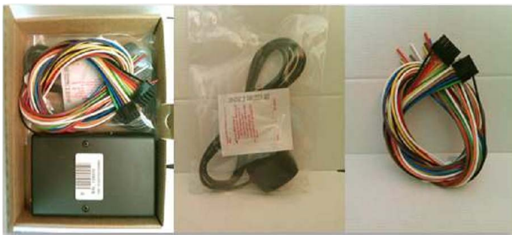
Рис.2. Устройство FM Tco3, кабели питания и ввода/вывода, а также антенна GPS.
