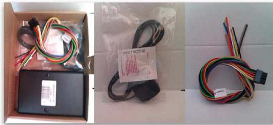
Рис.2. Устройство FM Eco3, кабели питания и ввода/вывода, а также антенна GPS.
